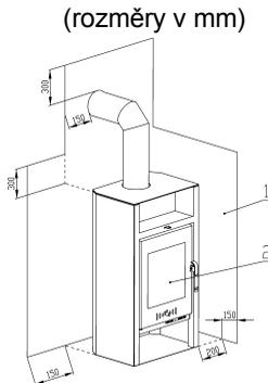
1 – ochranná clona palivového spotřebiče a kouřovodu chránící okolní hořlavé stavební konstrukce před jejich tepelnými účinky
