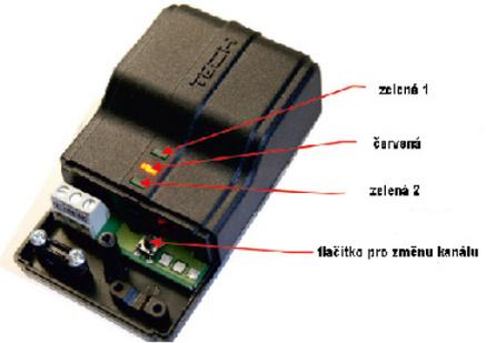
V předním krytu přijímače jsou umístěny 3 kontrolky:
